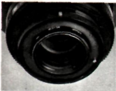
ФОТО 2. ПРИСОЕДИНИТЕЛЬНАЯ ЧАСТЬ ОБЪЕКТИВА С УСТАНОВЛЕННЫМ ФИЛЬТРОМ
